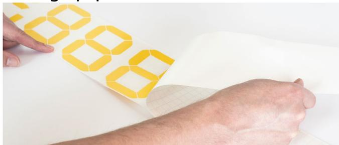
Legen Sie den Folienzuschnitt mit der Folienseite nach unten auf einen ebenen, sauberen Untergrund. Lösen Sie dann langsam das
